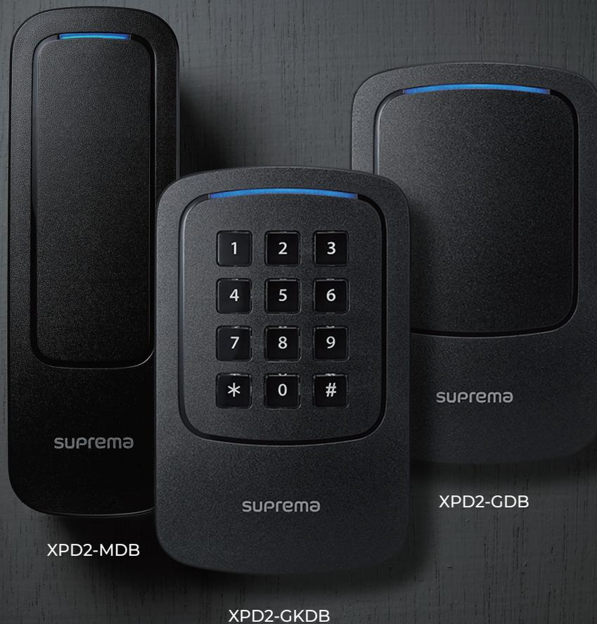
XPass D2 は、Suprema の最新 RFID 技術とマルチハードウェアプラットフォームをベースにした屋外用コンパクト RFID リーダーで、Suprema の CoreStation などの中央管理型入退管理システム用に最適化されています。マルチフォームファクター技術を使用すると、縦割りタイプ、ギャングボックスタイプ、およびギャングボックスキーパッドタイプのすべてに対応できます。デュアル周波数（125 kHz/13.56 MHz）の RFID 技術を採用した XPass D2 は、最新のモバイル通信技術である NFC および BLE を使用したモバイルカードにも対応しています。堅牢な IP65/IP67 等級の防塵および防水性能と IK08 等級の耐衝撃性を備えた構造になっており、過酷な環境や屋外での設置に適しています。
